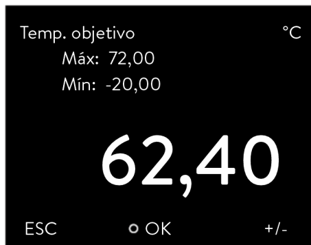
Fig. 62: Introducción de la temperatura objetivo
